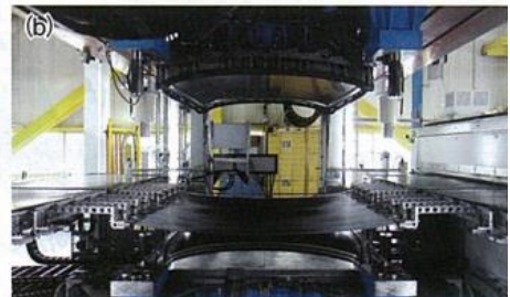
図6 RTMの成形工程 (a)ロールから炭素繊維を引き出す、(b)プリフォームを成形する型の上に繊維をセット、(c)接着剤を塗布して型を閉じプリフォームを固めてトリミングする、(d)プリフォームをロボットでRTM成形機に投入。
