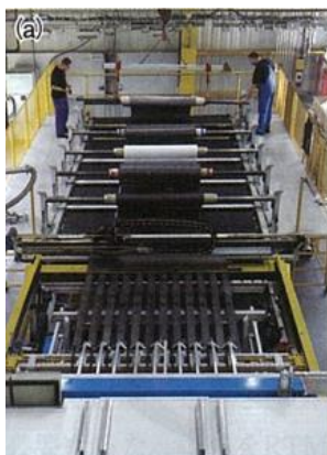
図6 RTMの成形工程 (a)ロールから炭素繊維を引き出す、(b)プリフォームを成形する型の上に繊維をセット、(c)接着剤を塗布して型を閉じプリフォームを固めてトリミングする、(d)プリフォームをロボットでRTM成形機に投入。
