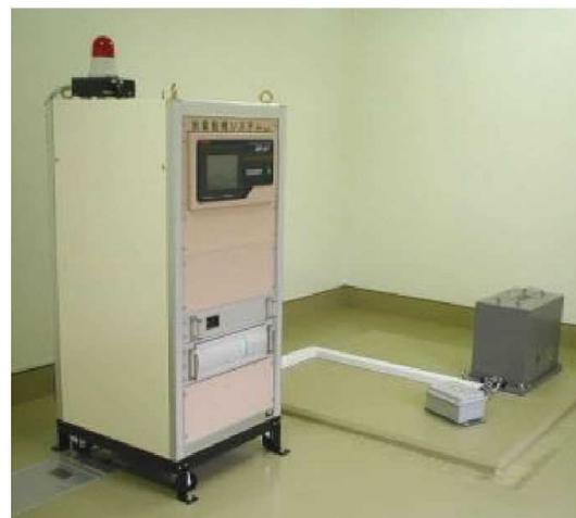
図2 新幹線早期地震検知システムの地震計
